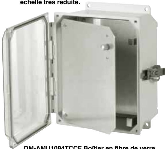
OM-AMU1084TCCF Boîtier en fibre de verre à charnière moulée intégrée, fenêtre en polycarbonate transparent et verrou tournant cadénassable. Montré avec OM-HFPU108, panneau avant plein vendu à part.
