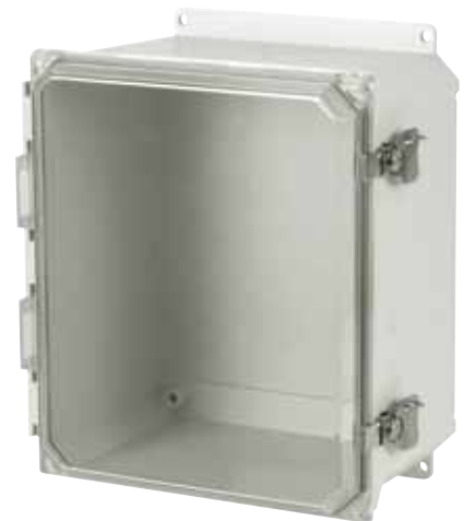
Boîtier fibre de verre OM-AMU1206TCCF à charnière moulée intégrée, couvercle polycarbonate transparent, verrou tournant cadénassable et bride de montage.
