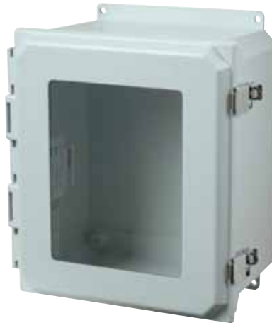
OM-AMU1426LWF boîtier en fibre de verre à face avant surélevée et charnière en acier inox, 2 verrous à enclenchement cadénassables, fenêtre de regard et bride de montage.
