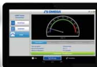
UWBT-TC-UST avec capteur KMQSS fixé, associé à un Samsung Galaxy Tab (capteur et tablette d'affichage de la température non fournis). Représenté à échelle réduite.
