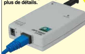
Le récepteur hôte avec Ethernet UWTC-REC3 est compatible avec les transmetteurs des séries UWTC, UWRTD, UWRH et UWIR et se connecte directement à votre réseau ou à Internet, sans passer par un ordinateur.
