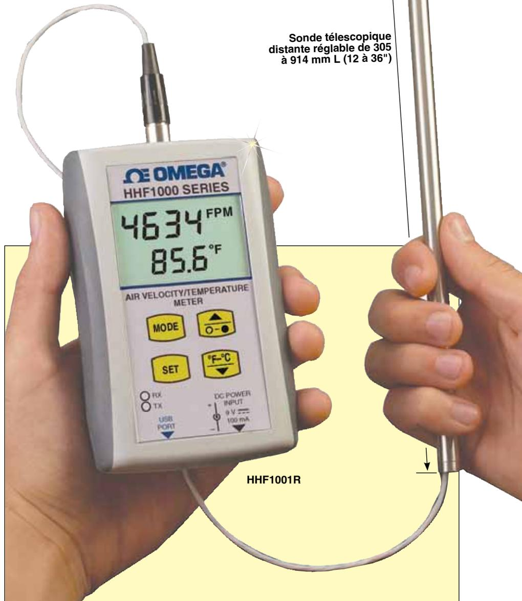
Les instruments portables de mesure de la vitesse/température de l'air de la série HHF1000 sont destinés aux laboratoires de recherche et développement, aux applications de CVC et autres procédés industriels. Le capteur comprend trois éléments RTD : l'un mesure la température de l'air et les deux autres déterminent sa vitesse en mesurant la perte de chaleur du capteur RTD due à son
