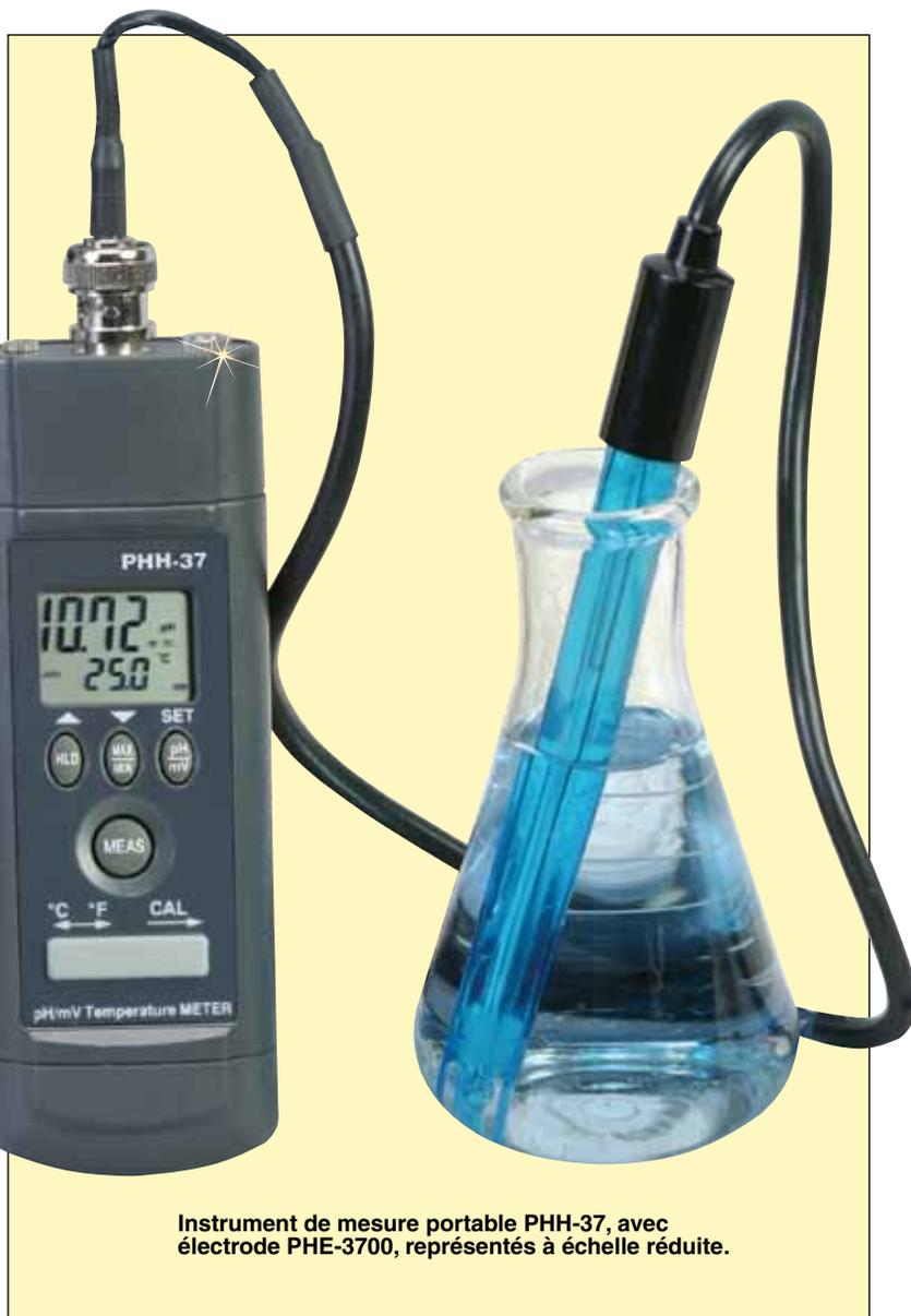
Instrument de mesure portable PHH-37, avec électrode PHE-3700, représentés à échelle réduite.
