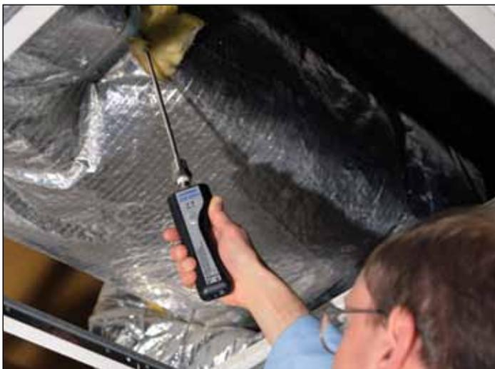
Figure 1 : Mesure de température des gaines d'air à l'aide de l'UWBT-RTD-M12
