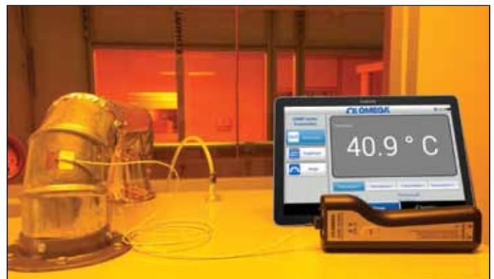
Figure 3 : L'UWBT-RTD-TB surveille la température des gaz d'échappement
