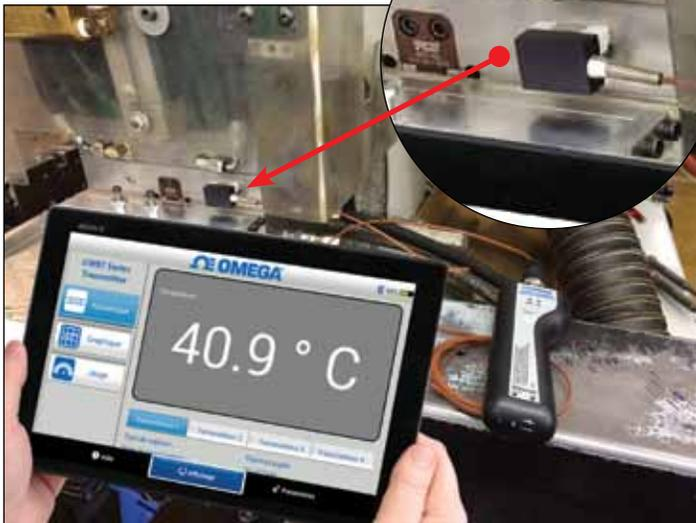
Figure 1 : Un transmetteur UWBT-TC-UST surveille la température du moule
