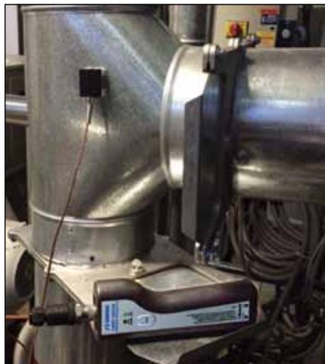
Figure 5 : Sonde magnétique 88401K montée sur un système de réalisation de vide
