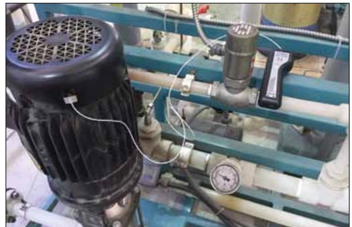
Figure 7 : Capteur SA1-RTD monté sur le moteur de la pompe
