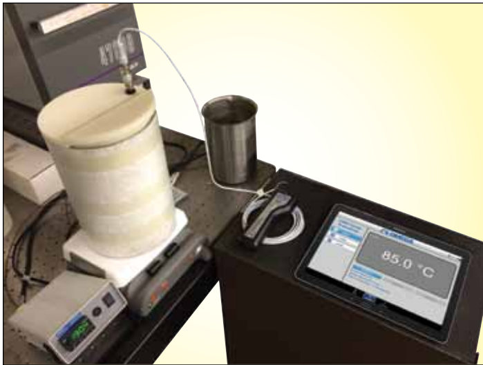
Figure 1 : Un UWBT-RTD-TB enregistre les données de température d'une sonde RTD PR-31
