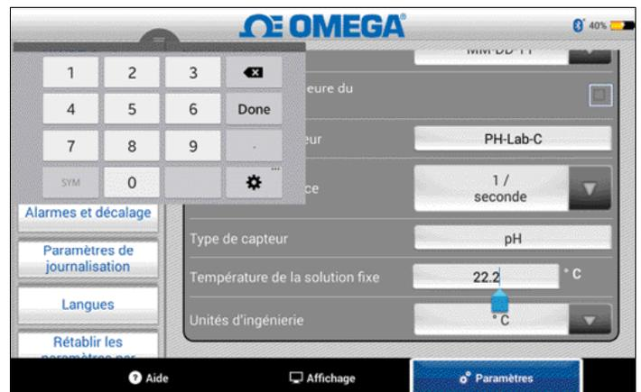
Figure 3 : Entrée d'une température de solution fixe
