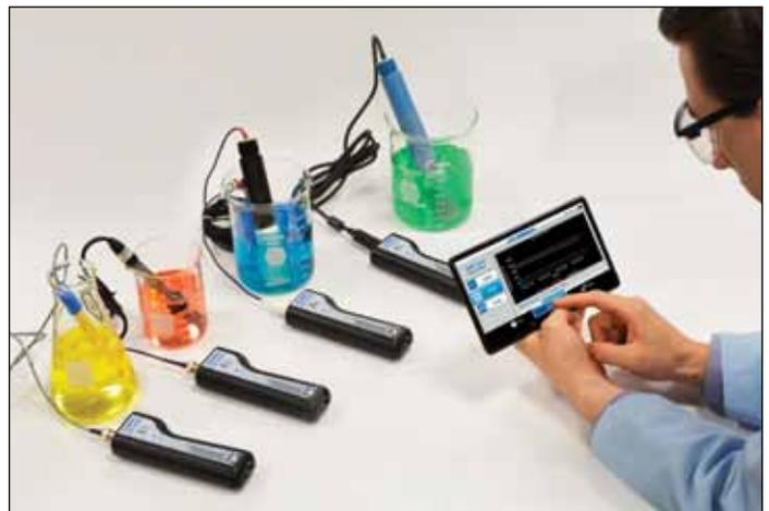
Figure 2 : Quatre transmetteurs UWBT-PH connectés à une tablette
