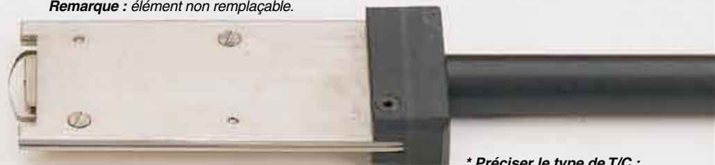
Toutes les sondes de la série 88000 sont fournies avec câble rétractable [s'étend jusqu'à 1,5 m (5')] et connecteur miniature mâle.
