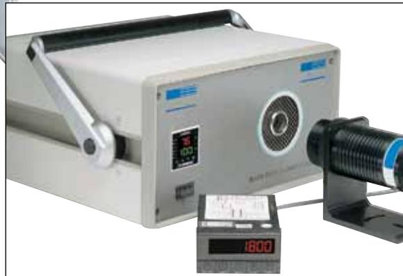
Représentation de l'étalonnage d'un pyromètre OS1552-A. Consultez [omega.fr](http://omega.fr) pour en savoir plus.
