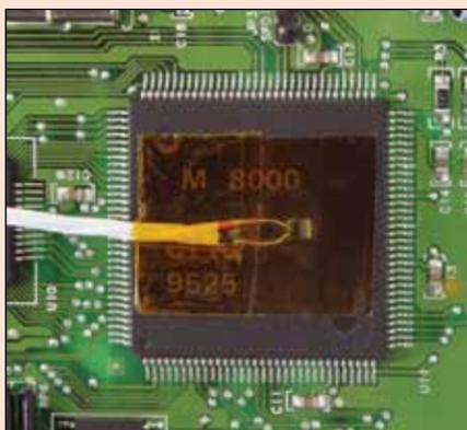
Le capteur auto-adhésif est idéal pour un placement « ciblé » sur des surfaces plates ou courbes. Une fois en place, le capteur peut être utilisé « tel quel » pour la mesure de température sur des machines-outils, appareils électroniques, structures ou autres emplacements nécessitant un contrôle de la température.
