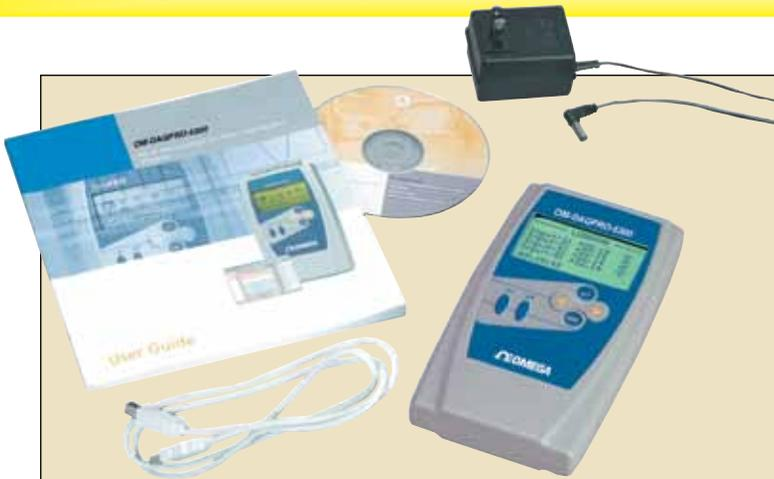
L'enregistreur de données OM-DAQPRO-5300-UNIV intègre un logiciel pour Windows fourni sur CD-ROM, un adaptateur 100 à 240 Vca, un câble USB, un certificat d'étalonnage NIST, un manuel d'utilisation et une mallette de transport.
