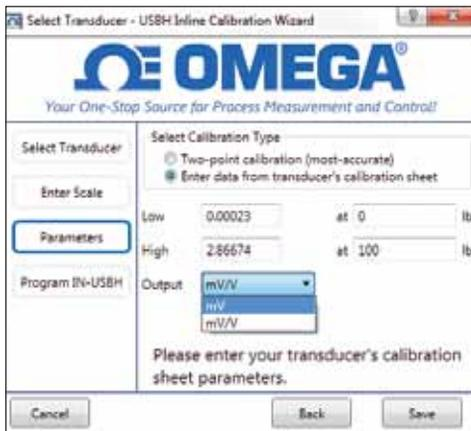
**Étalonnage sur site** – Le conditionneur IN-USBH peut facilement être étalonné sur site grâce à l'assistant logiciel, aux poids connus ou à la feuille d'étalonnage du transducteur. Voir le Guide de démarrage rapide IN-USBH pour obtenir des instructions d'étalonnage sur site.
