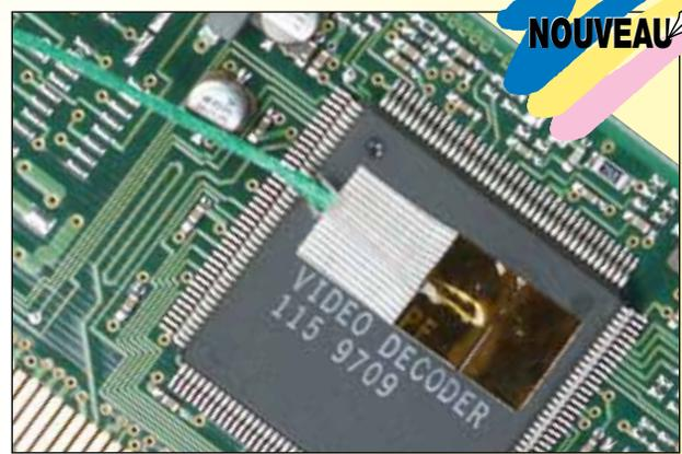
La bande de fixation auto-adhésive est idéale pour un positionnement « ciblé » de l'élément de détection. Une fois monté, l'élément peut être utilisé tel quel pour les applications de surveillance de la température des composants électroniques pendant la fabrication des cartes, ou similaires. Il peut également être collé à l'aide du ciment OMEGABOND™ pour hautes températures.
