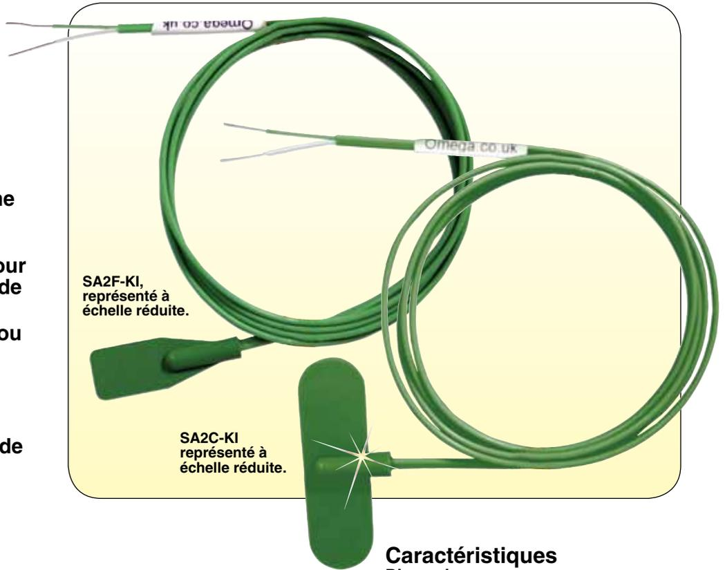
Ces capteurs sont disponibles en deux types de montages différents pour les surfaces planes ou courbes. Le capteur de thermocouple intégral est collé sur la surface interne de la bande en aluminium auto-adhésive, qui assure des réponses plus rapides.
